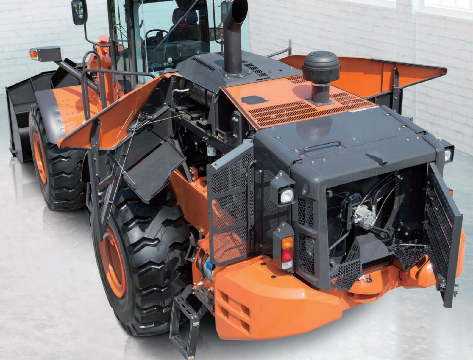
写真はオプションの1960 kg カウンタウエイト、プレクリーナ（サイクロン式）、バケットシリンダロッドガードを装備しています。
