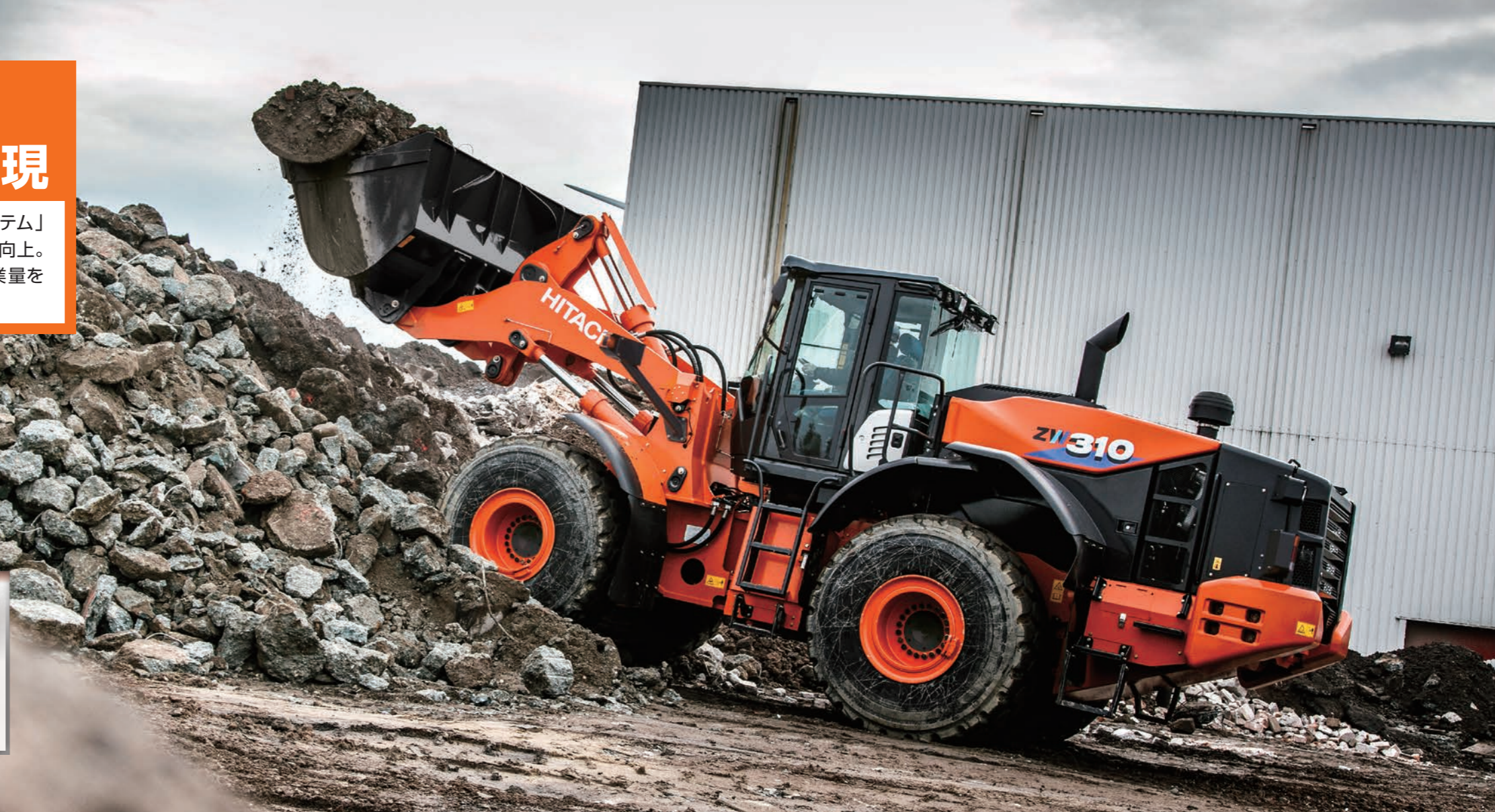
写真はオプションのラジアルタイヤ、フルフェンダ（マッドフラップ付き）、ブレイクレーナ（サイクロン式）、後方作業灯、バケットシリンダロッドガードを装着しています。
